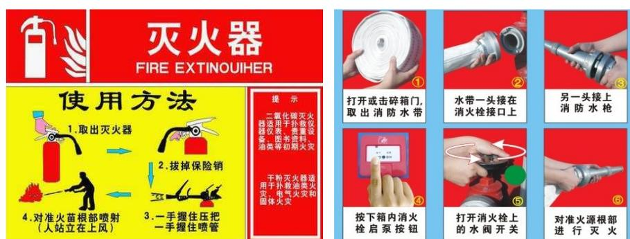
注：除酸碱式灭火器外，其他灭火器使用时不能颠倒，也不能横卧，否则灭火剂不会喷出。
